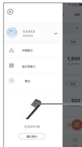
②選擇圖示，顯示與儀器的連接畫面。
