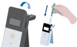
⑥ 打開測量腔蓋，將檢測棒置入測量腔。
